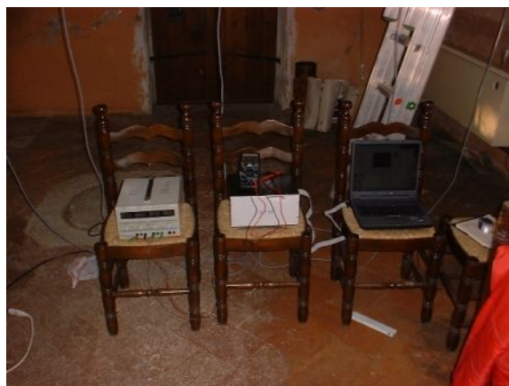
Figura 2: catena di misura (sistema di acquisizione, scatola di interconnessione, alimentatore)
